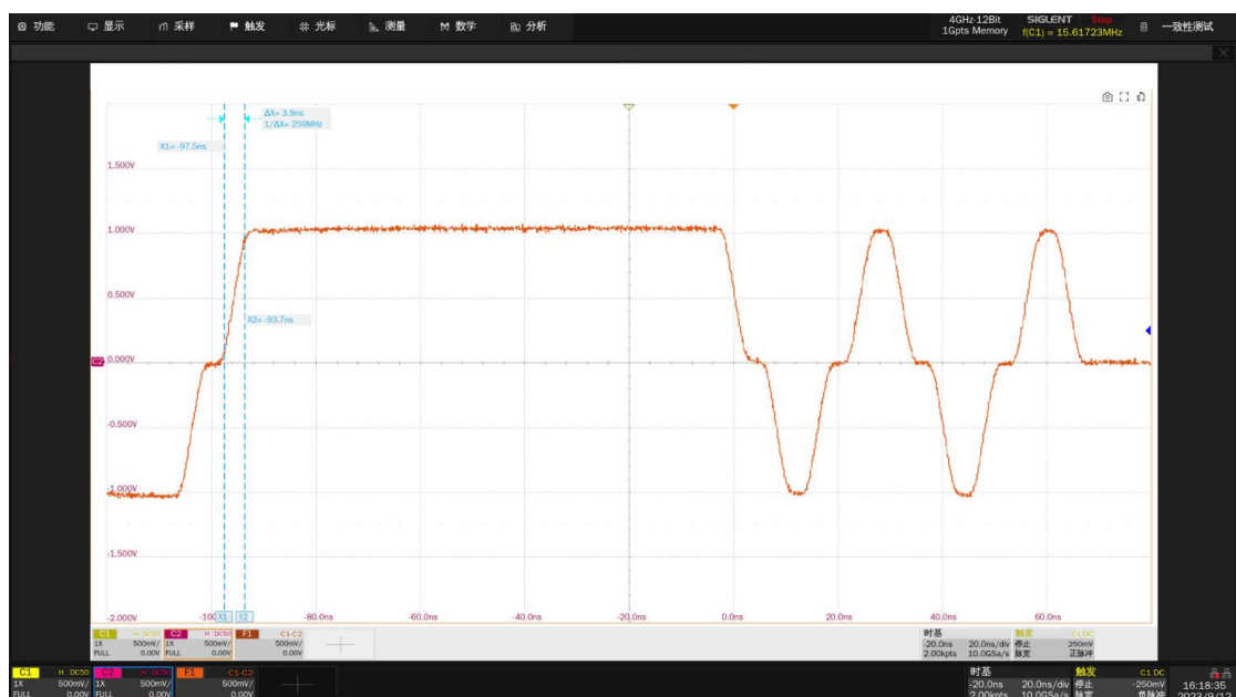
图 6-11 上升时间测试波形的展开细节
